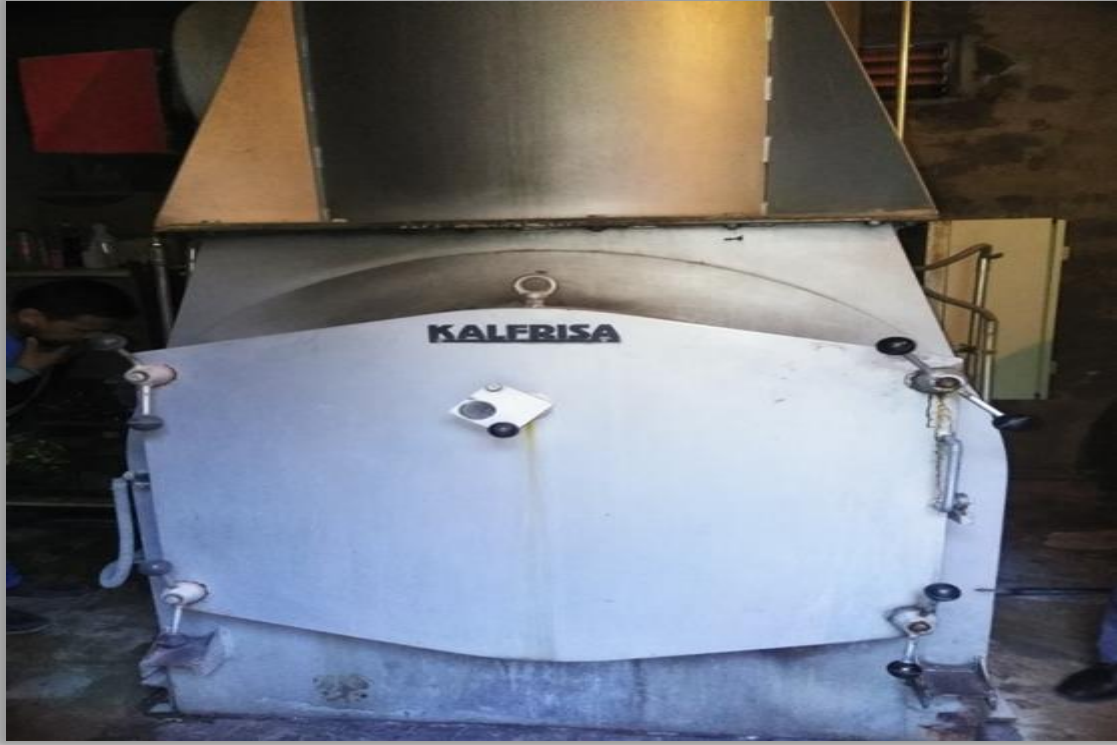
شكل 4. محرقة النفايات الطبية من نوع KALFRISA موديل PS المستخدمة في المركز الطبي البيضاء
