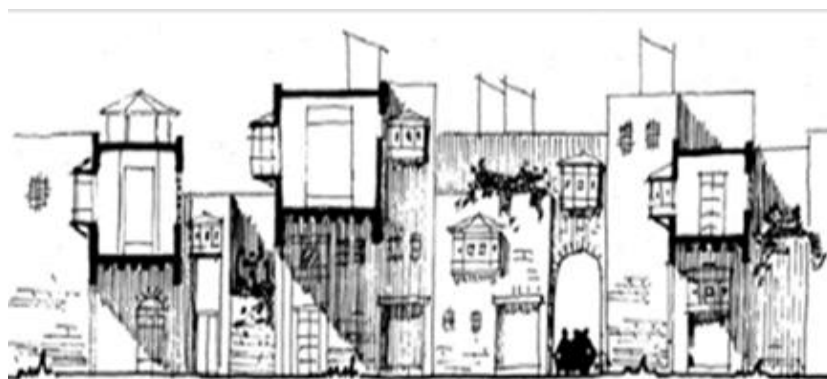
شكل 4. قطاع وواجهة تخيليه توضح كمية الظلال الذاتية على أجزاء المباني في النسيج العمراني المتضام المصدر: https://jur.journals.ekb.eg/article
