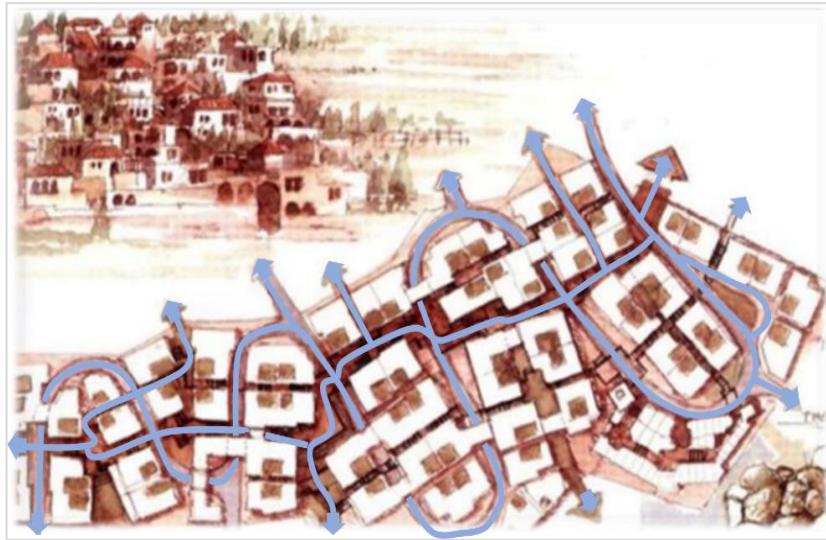
شكل 14. رسم للمعماري رفعة الجادري توضح حركة الهواء في النسيج المتضام
