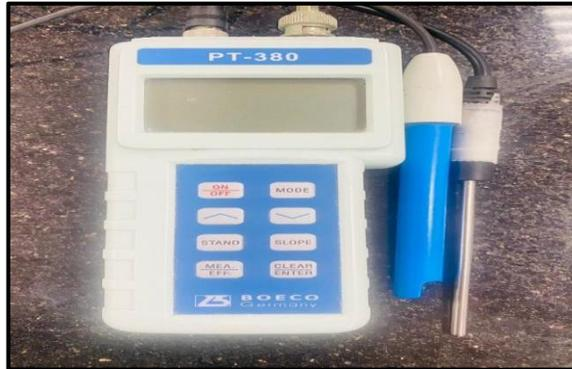
الشكل (3). جهاز قياس الأس الهيدروجيني.
