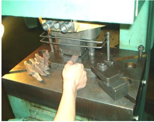
Fig. 6: The cutting die
