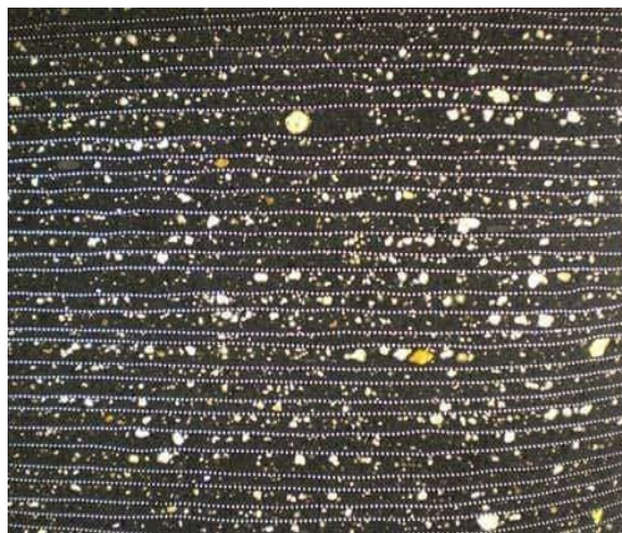
الصورة رقم (8) تبين الخرسانة الشفافة في الأسقف
