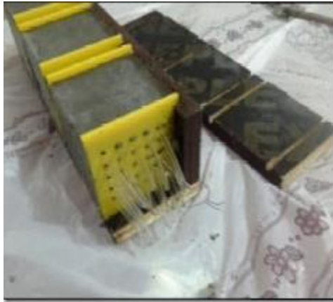
الصورة رقم (4) تبين معالجة العينات بعد فك القوالب
