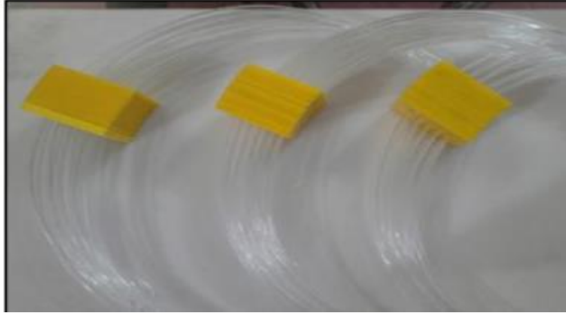
الصورة رقم (2) توضح تمرير الألياف البلاستيكية خلال الثقوب
