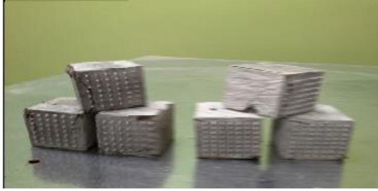
الصورة رقم (5) تبين القوالب بعد اختبار الضغط
