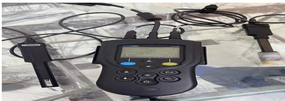
الشكل (6) يوضح جهاز قياس الأكسجين الذائب لعينة المياه.
